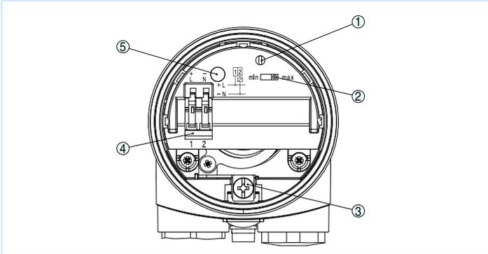
Отсек электроники и подключения - бесконтактный переключатель
